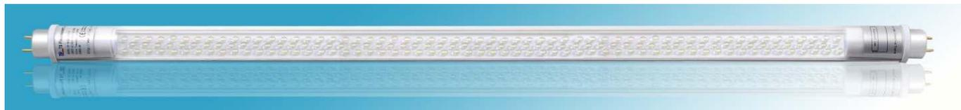
I tubi a led sostituiscono i tubi fluorescenti convenzionali (al neon) senza modificare l'impianto esistente ma solo rimuovendo lo **starter** (sempre). Hanno una durata di circa **50000 ore**, cioè circa 10 volte i tubi tradizionali con un risparmio di energia dal 50% al **67%**, già visibile alla prima bolletta elettrica.
